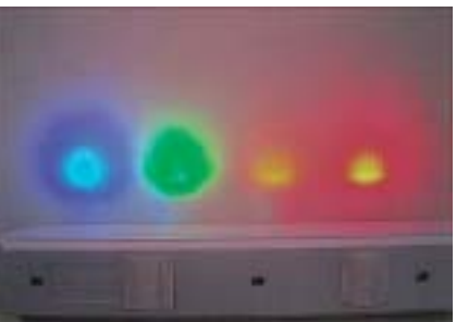
写真12 常夜灯の発光スペクトル：写真11の前にトレーシングペーパーを置く。
