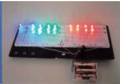
写真2 単三電池6本で点灯した虹ボード
