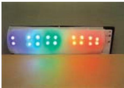
写真5 トレーシングペーパーで前面を覆った虹ボード：LEDの発光が減衰し、分散する。
