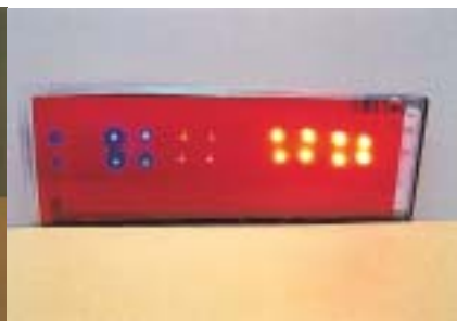
写真6 赤セロファンの可視吸収スペクトル：写真5の前に赤セロファンを置く。
