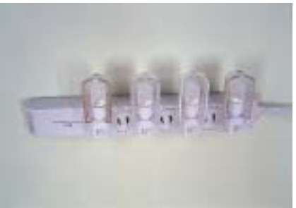
写真10 テーブルタックに装着したLEDの常夜灯
