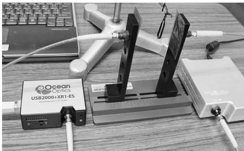
写真2 シャボン玉膜の干渉スペクトルを測定するための測定系
