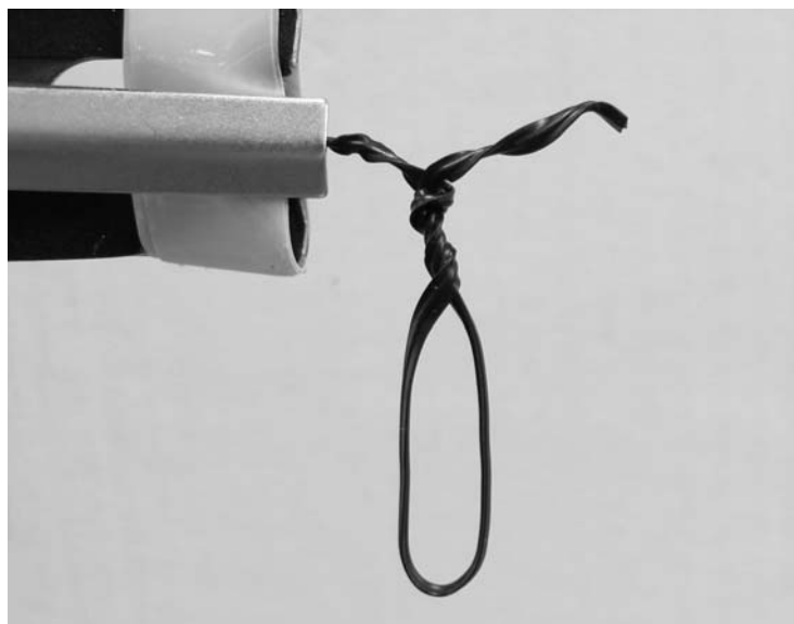
写真3 シャボン玉の膜を作るために用意したビニール被覆針金製の枠
