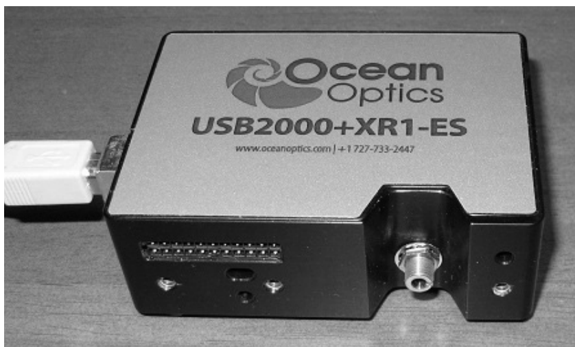
写真 1 小型マルチチャンネル分光器 USB2000+XR1-ES の外観
