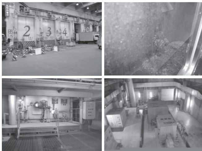
〔左上〕可燃ごみの投入ステージ 〔右上〕クレーンでごみを攪拌 〔左下〕1号炉でごみを燃焼中 〔右下〕余熱を電力として回収 出所：2009年9月2日に筆者撮影。
